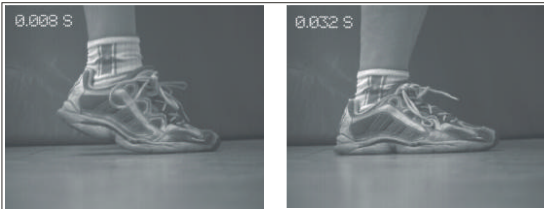
FIGURA 2: Instantes en los que suceden los dos primeros picos de fuerza en la amortiguación de una caída desde 0.75 m. El primer pico relaciona con el impacto de las cabezas de los metatarsos (izquierda) y el segundo con el impacto del talón (derecha). Las imágenes han sido obtenidas a 1000 Hz con una cámara de alta velocidad, Redlake MotionScope M1, sincronizada con una plataforma de fuerzas.
