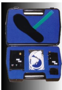
Figura 1. Sistema de registro de presiones plantares PDM 240.
